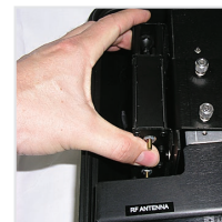
4. Insérer le nouveau duplexeur dans le boîtier
