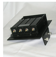
3. Sélectionner le duplexeur au canal correct
