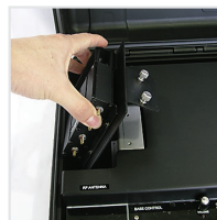
2. Retirer le duplexeur du boîtier
